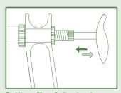
Funktionsprüfung: Spritze ein- oder zweimal betätigen.
