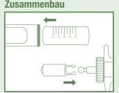
Glaszylinder vorsichtig zurück ins Gehäuse einfügen. Kolben am Handgriff festmachen.
